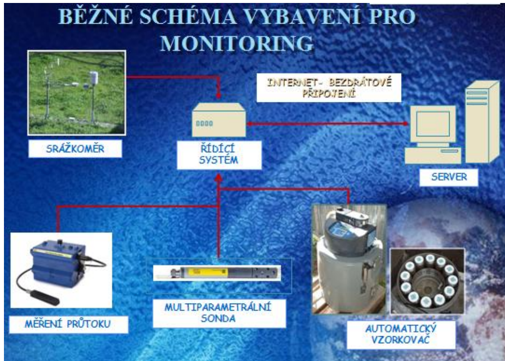
Obrázek č. 5 – schéma sestavy pro monitoring
