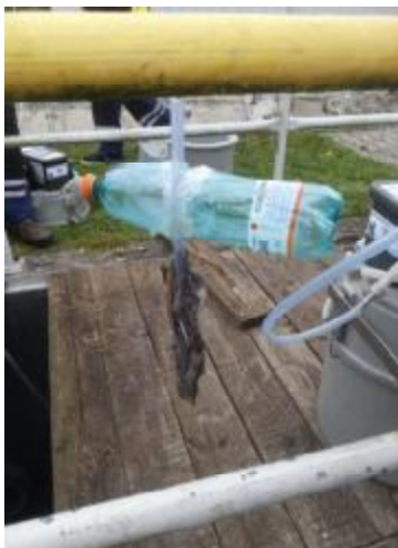
Obrázek č. 3 - sací koš obalený hrubými nečistotami
