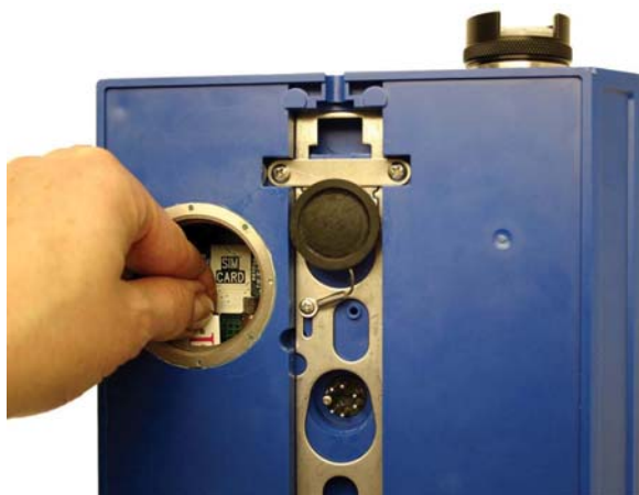
SIM karta je přístupná přes vodotěsné šroubovací víčko umístěné na spodní straně modulu
