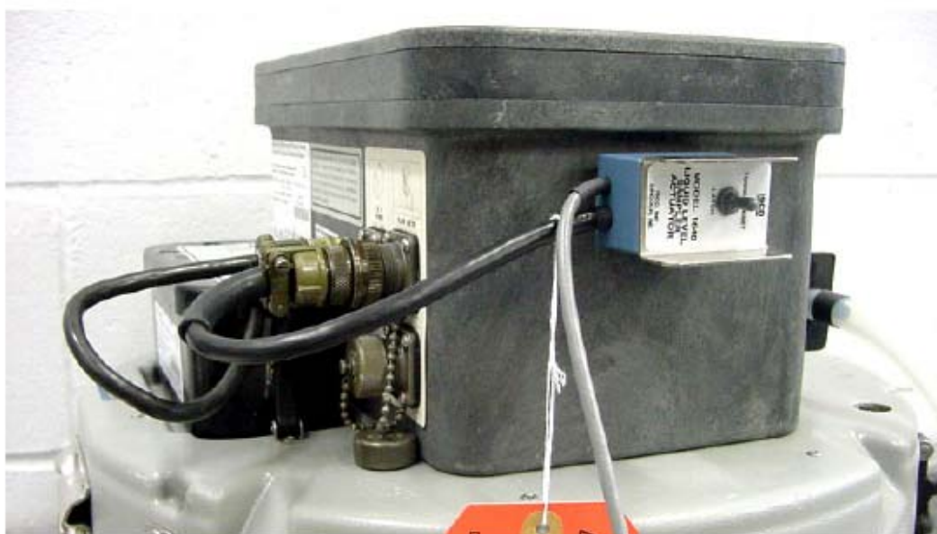
Obrázek 2-1 Hladinový snímač typ 1640 nainstalovaný na vzorkovači
