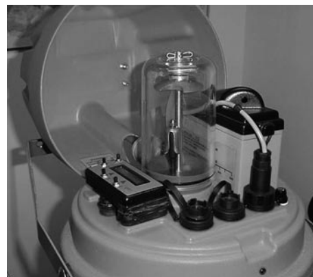
Automatický přenosný vzorkovač s vakuovým čerpadlem
