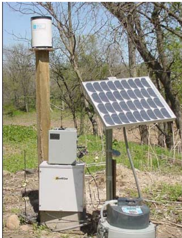
Srážkoměr 674 s přesným překlopným člunkem a 3-bodovým nivelačním systémem pro snadné nastavení.
