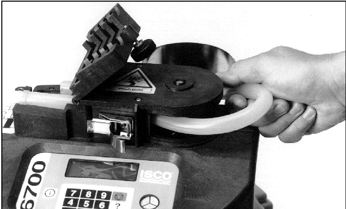
Obrázek 6-1 Vyjmutí a výměna hadice čerpadla
