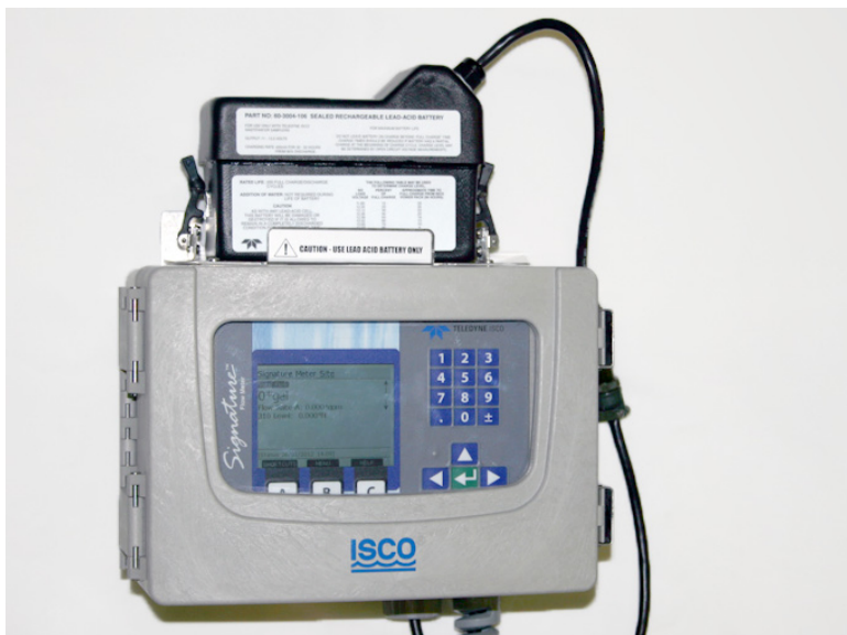
Obraz 5-8 Signature s nainstalovanou záložní baterií
