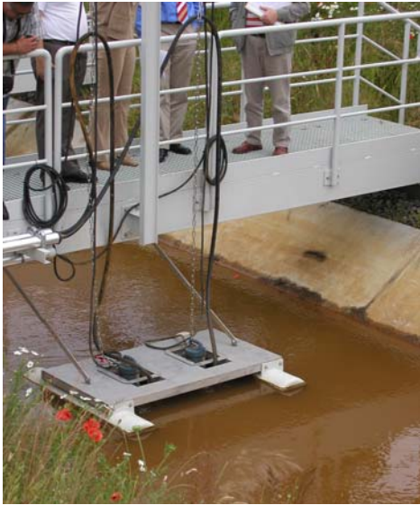
Obrázek 3 Speciální uchycení čerpadel na plovákovém mechanismu
