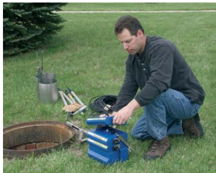
Sondy průtokoměrů Isco mají ultrazvukový vysílač a přijímač pro měření rychlosti proudění a měření hladiny je prováděno tlakovým čidlem
