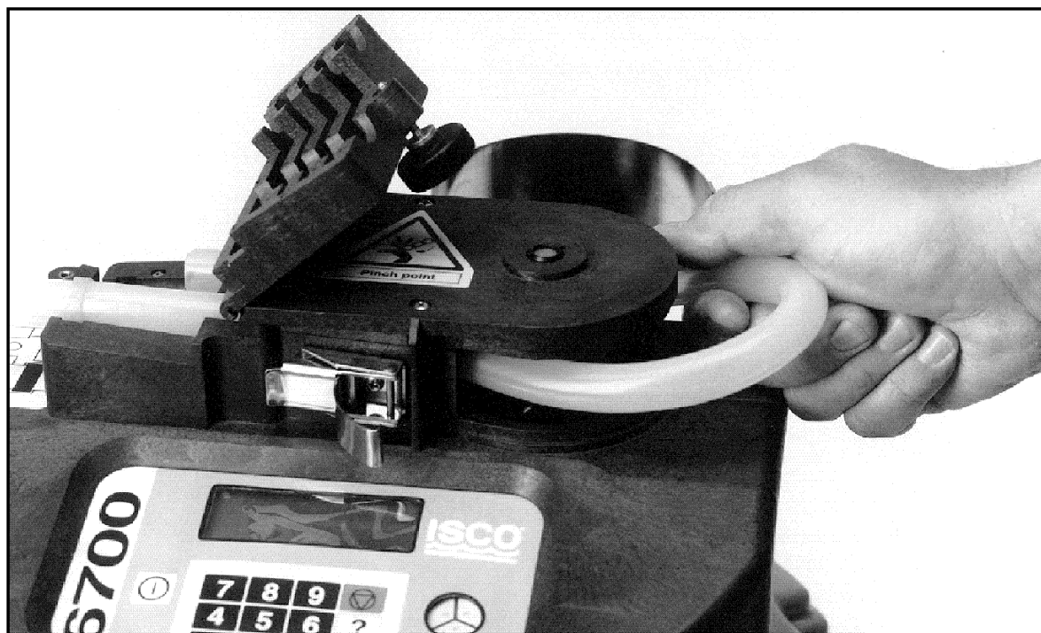
Obrázek 6-1 Vyjmutí a výměna hadice čerpadla
