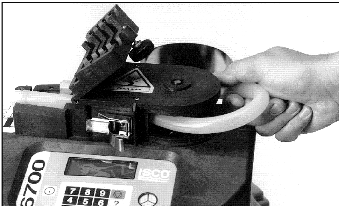
. Obrázek 6-1 Vyjmutí a výměna hadice čerpadla
